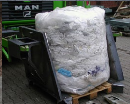
Ballenaufnahme-Adapter als Kipphilfe für Pressmüllwagen
